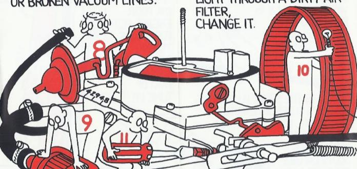
9 FUEL FILTERS TRAP DIRT BEFORE GAS REACHES THE CARBURETOR. A CLOGGED FILTER STARVES THE ENGINE OF GAS. THE FUEL FILTER SHOULD BE REPLACED AS PART OF A TUNE-UP.
