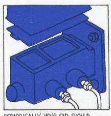
THE MASTER CYLINDER, HEART OF THE BRAKE SYSTEM, CONTAINS A RESERVOIR FOR BRAKE FLUID. IT IS LOCATED ON THE FIREWALL AND SHOULD BE CHECKED PERIODICALLY TO ENSURE THE PROPER FLUID LEVEL.
